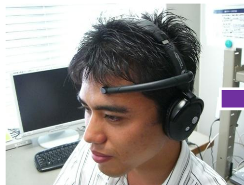
市販の脳波センサ(MindSet)を筋電位の取得に利用している
