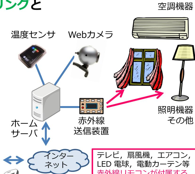
テレビ, 扇風機, エアコン, LED電球, 電動カーテン等赤外線リモコンが付属する機器であれば、何でも操作することができる。
